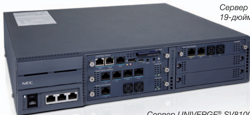
Сервер UNIVERGE® SV8100. 9,5-дюймовое шасси, 3 слота
